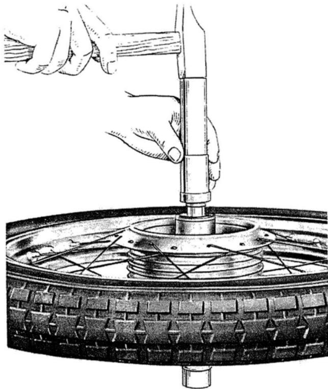
Fig. 43 - Pressatura nel mozzo del secondo cuscinetto già montato sul perno.
