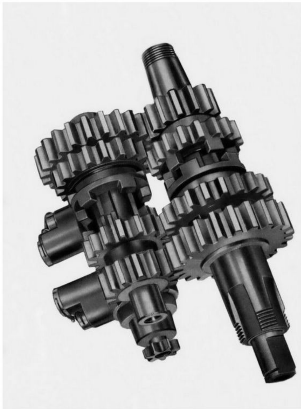
Fig. 48 - Gruppo cambio montato in 1ª velocità
