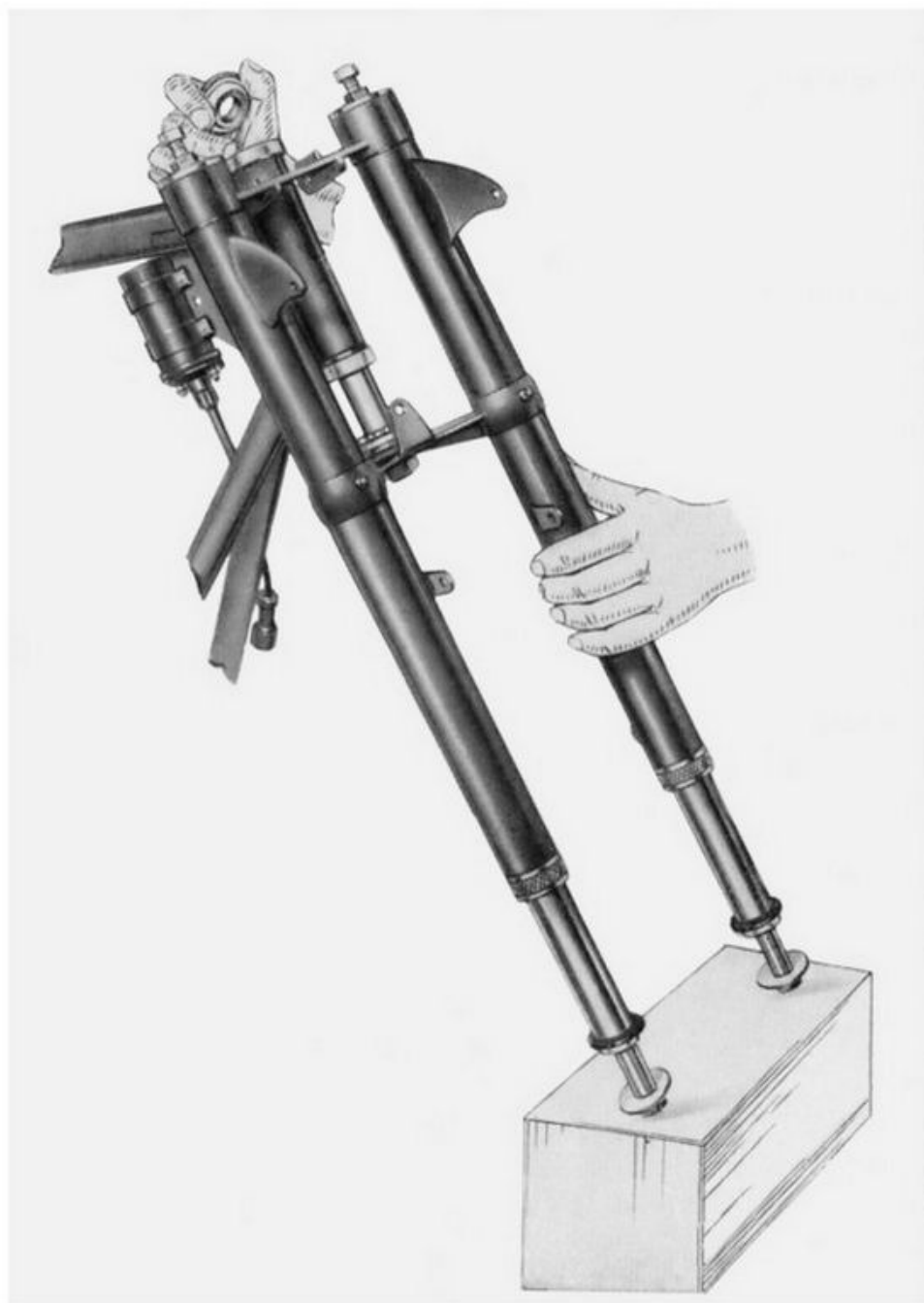
Fig. 64 - Smontaggio della forcella telescopica dal telaio
