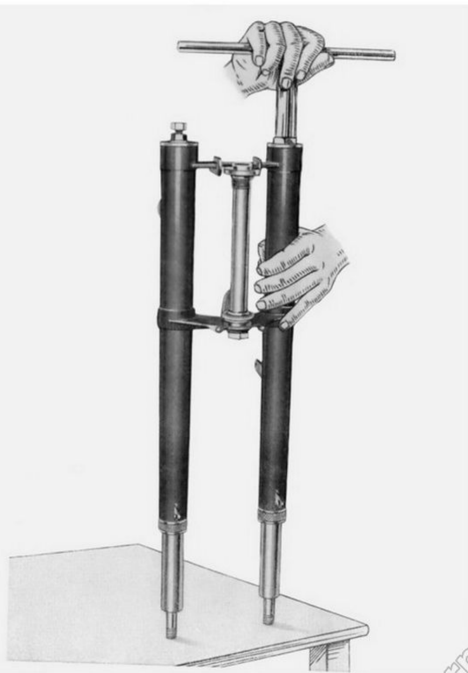
Fig. 65 - Come si svitano i manicotti superiori per fissaggio molle forcella
