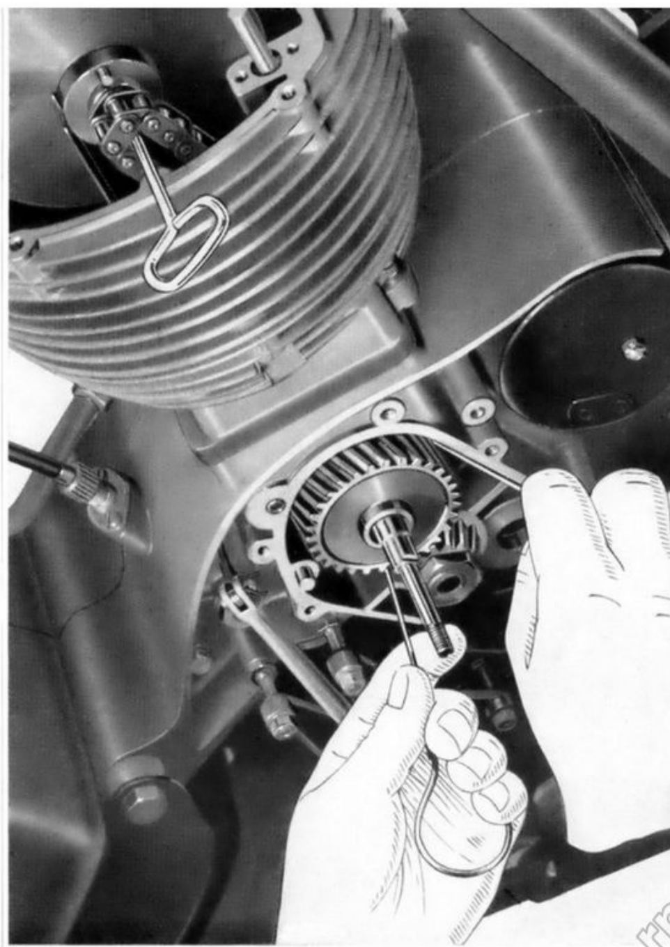
Fig. 25 - Smontaggio della catena distribuzione dal pignone
