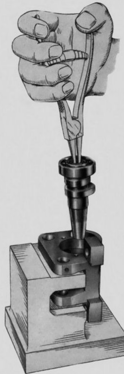
Fig. 14 - Montaggio dell'albero camme con cuscinetto a sfere nel castelletto
